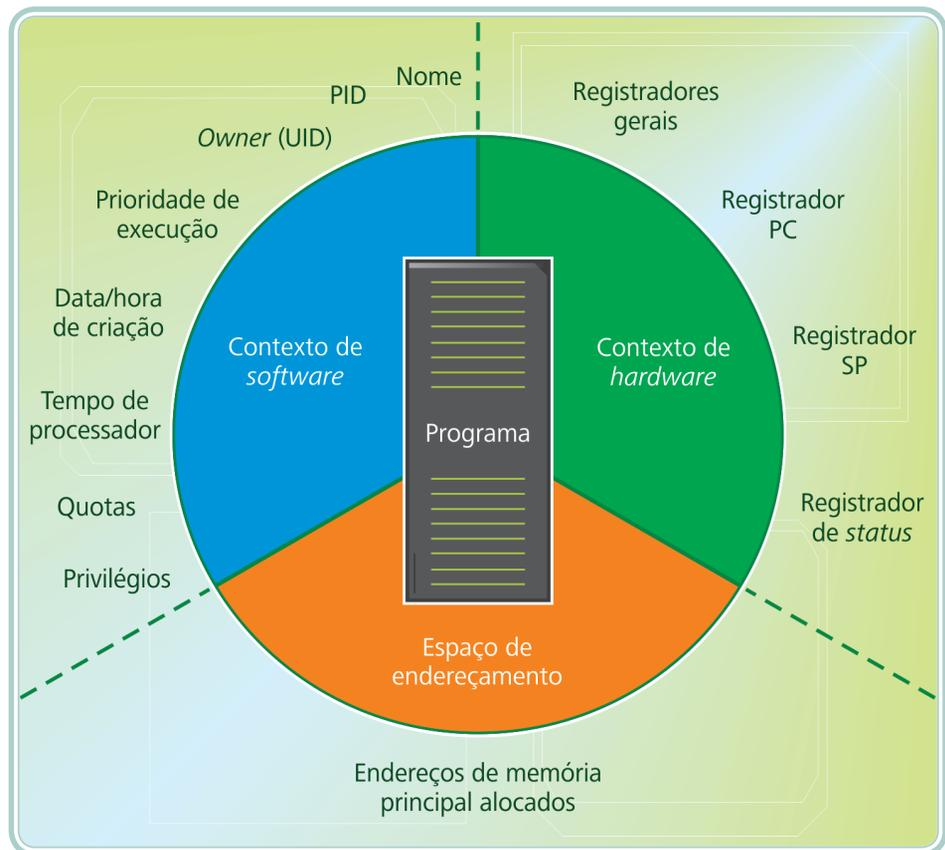
**Figura 4.2: Características da estrutura de um processo**
