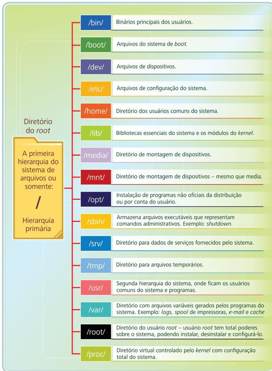
**Figura 8.7: Estrutura de diretórios padrão do sistema operacional Linux**
